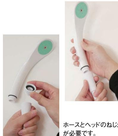
ヘッドとホースを接続している金具を握り、ヘッドを左に回して取り外します。新しいヘッドにパッキンを付けて金具に差し込み、右に回して取り付けます。
